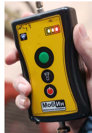
● Smart-бокс, при помощи которого идет беспроводное считывание данных с датчиков оборудования.
